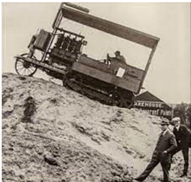
Trator de Holt, em testes na lama das cercanias do rancho de Benjamin Holt, cercanias de Stockton, Califórnia. É semelhante aos usados durante a Grande Guerra para rebocar peças de artilharia. Autor desconhecido. Holt-Atherton Special Collections , University of the Pacific.
